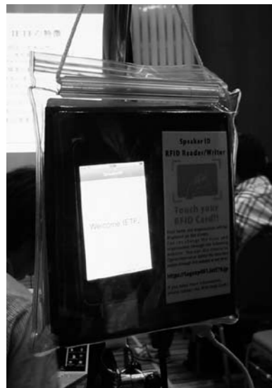
■ 発言者のRFIDを読み取るためにマイクスタンドに設置されたRFIDリーダー
